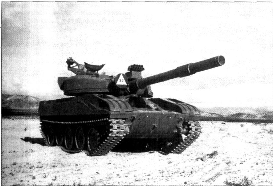
Визуальный макет (VISMOD) танка Т-72 с использованием танка М551 «Шеридан». Национальный тренировочный центр армии США, Форт-Ирвин
