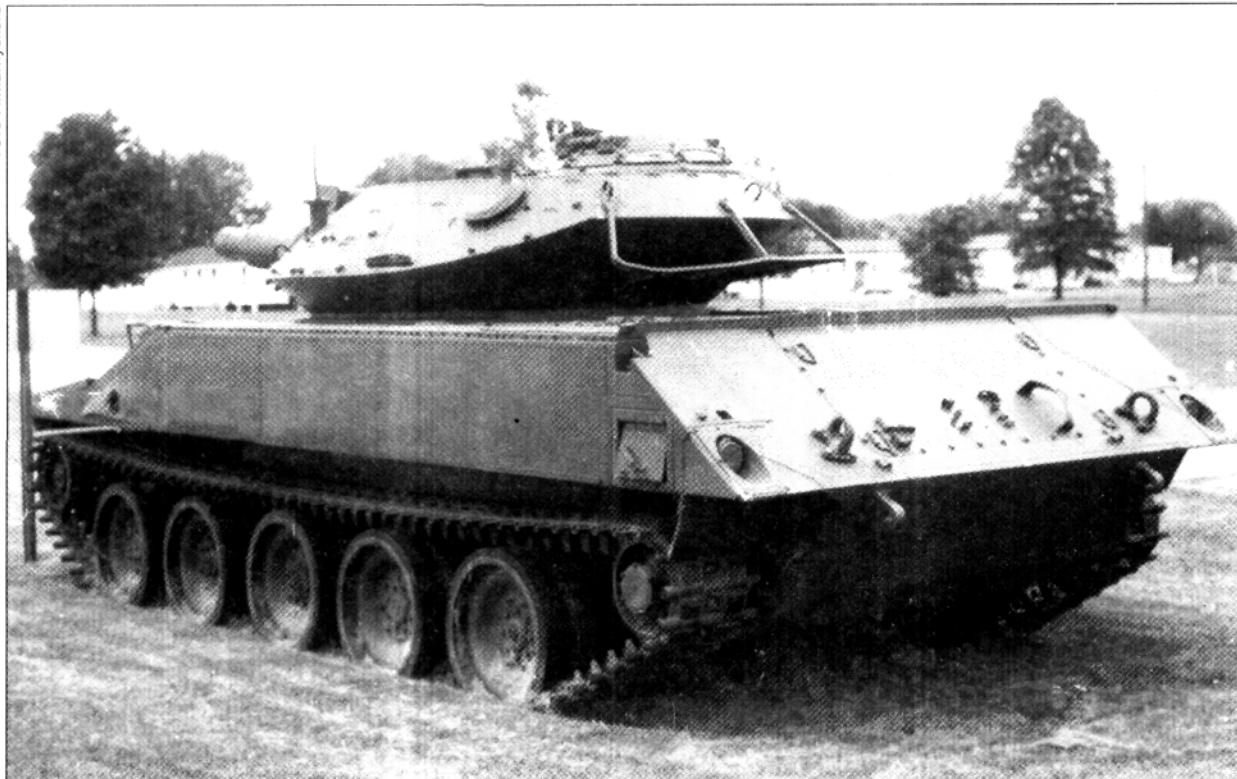
Предсерийный образец танка М551, вид с кормы. По периметру корпуса еще отсутствуют чехлы с водонепроницаемым ограждением для движения на плаву
