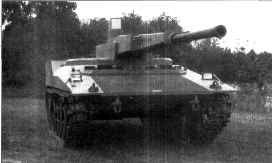
Второй вариант танка RDF/LT с дистанционно управляемой пушкой ARES
