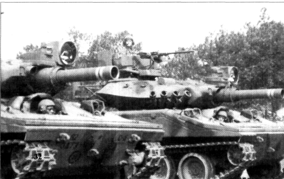
«Шериданы» 82-й воздушно-десантной дивизии. У правой машины на командирской башенке установлен лазерный дальномер
