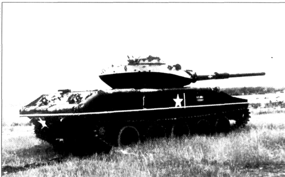
Опытный образец танка «Шеридан», вооруженный 105-мм пушкой EX35
